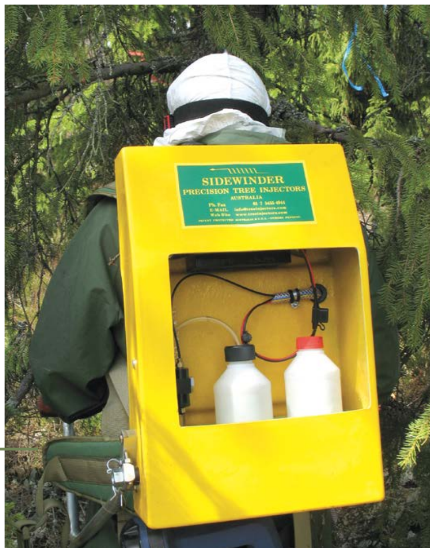
Kuva 2. SideWinderin kulmikas ratkaisu injektioainesten kuljettamiselle maastossa. Injektointi tapahtui repun vasemmalla sivulla olevasta kahvasta, jolla myös paineistettiin pullo. (valokuva Tiina Ylioja)
