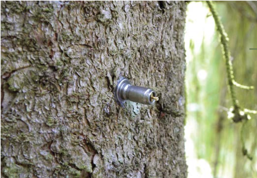
Kuva 3. Arborsystemsin Wedgle Direct-Inject laitteen injektointikärki kuusessa. (valokuva Curt Almqvist, Skogforsk)
